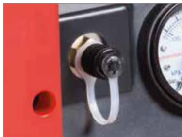
Vetro di ispezione in posizione ottimale e raccordo per lo scarico dell'olio per far defluire l'olio con più semplicità
