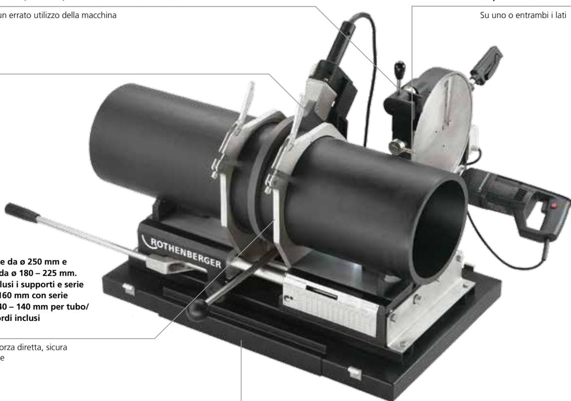
Assortimento completo della macchina (No. 55795A): macchina base con fresa elettrica, supporto termoelemento, termoelemento teflonato con regolazione termostatica o elettronica, serie morse base Ø 160 mm e 250 mm e supporto laterale tubi base Ø 160 mm e 250 mm, serie riduzioni e supporti tubo da Ø 40 - 140 mm e da Ø 180 - 225 mm, chiavi di servizio, cassa di trasporto con cassetto 800 x 520 x 765 mm (L x B x H) e cassetta in lamiera per riduzioni e supporti tubo.
