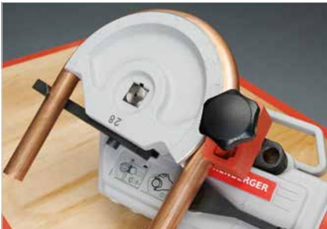
Segmenti di curvatura in alluminio con scala di misurazione integrata
