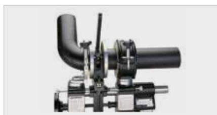
Morsa base girevole di 15° per parte, per la formazione di curve e segmenti
