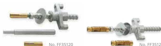
Il set (No. FF35120) comprende: asta filettata tipo G-B 160 mm, filetto M 12/20 mm (No. FF35129), rondella (No. FF 70166), dado M 12 (No. FF55150), 25 tasselli M 12 (No. FF 35122) e perni di fissaggio (No. FF35128).
