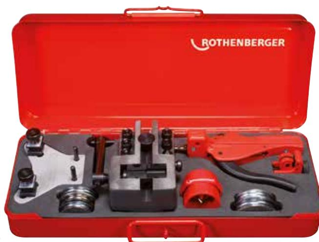
Il set (No. 26020) comprende: MINICUT 1 dia. 3 - 16 mm (No. 70401), sbavatore per interni ed esterni dia. 4 - 36 mm (No. 11006), apparecchi per colletti doppi DB 10 (No. 2.6013), set TUBE BENDER, dia. 4,75 - 10 mm (No. 24112), in cassetta di lamiera (No. 24022)
