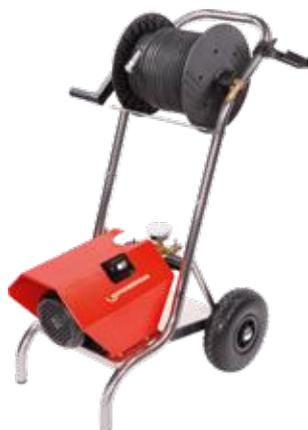
Contenuto: HD 13 / 100 (No. 76020), avvolgicavo incorporato e 20 m di cavo speciale ad alta pressione (No. 72812) e ugello per la pulizia delle tubazioni (No. 76089)
