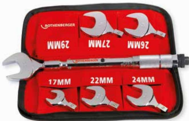
Il Set (10-70 Nm) comprende chiave dinamometrica (10-70 Nm) e 6 inserti da SW 17, 22, 24, 26, 27 e 29 mm per giunzioni di angoli di tubature da 1/4", 3/8", 1/2" e 5/16" secondo DIN 3866
