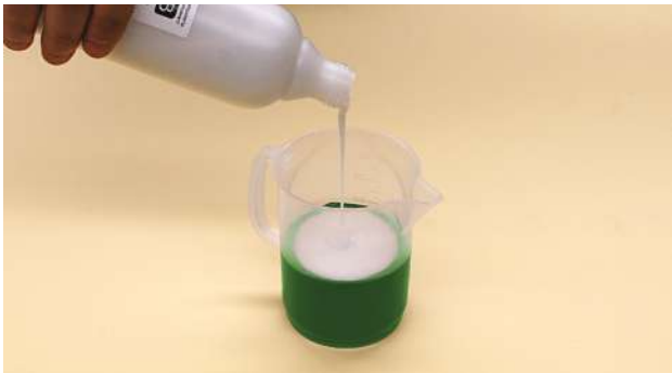
Verter los componentes A y B en la garrafa graduada, en proporción 1:1.
