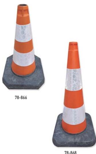
Fabricado en una pieza de PVC 100% reciclado. Todos los conos se suministran con 2 camisas reflectantes de 10cm. Provistos en la punta con agarre de 360° para facilitar su manipulación. Según normas EN13422 Clase R1B.
