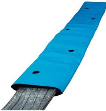
La protección de pvc permite proteger la eslinga o cinta de rozaduras leves y alargar su vida útil, no es anticorte. Temperaturas de uso: de 0º a 60º grados. Maxima resistencia a la intemperie.
