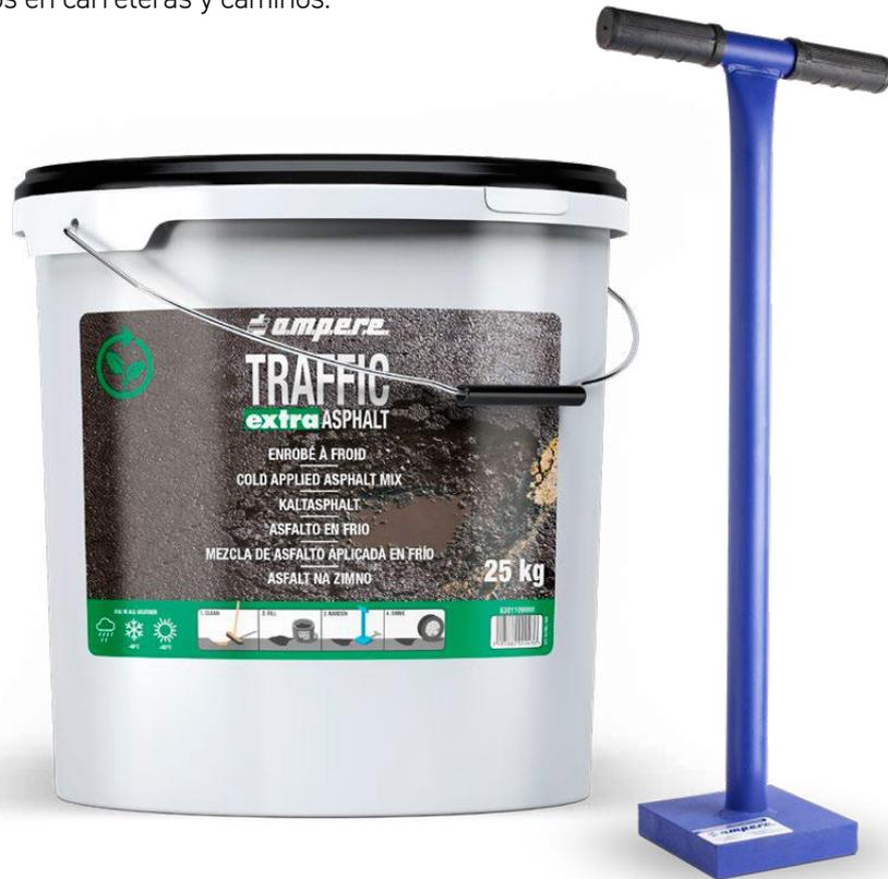
No se requiere imprimación para la aplicación. Limpiar la zona a reparar, rellenar con asfalto en frío y compactar con el apisonador manual Traffic Asphalt o con una placa vibratoria para áreas más grandes. Para lograr un resultado óptimo, aplicar la masa asfáltica en capas de 2 a 4 cm. Se puede circular inmediatamente después de compactar.
